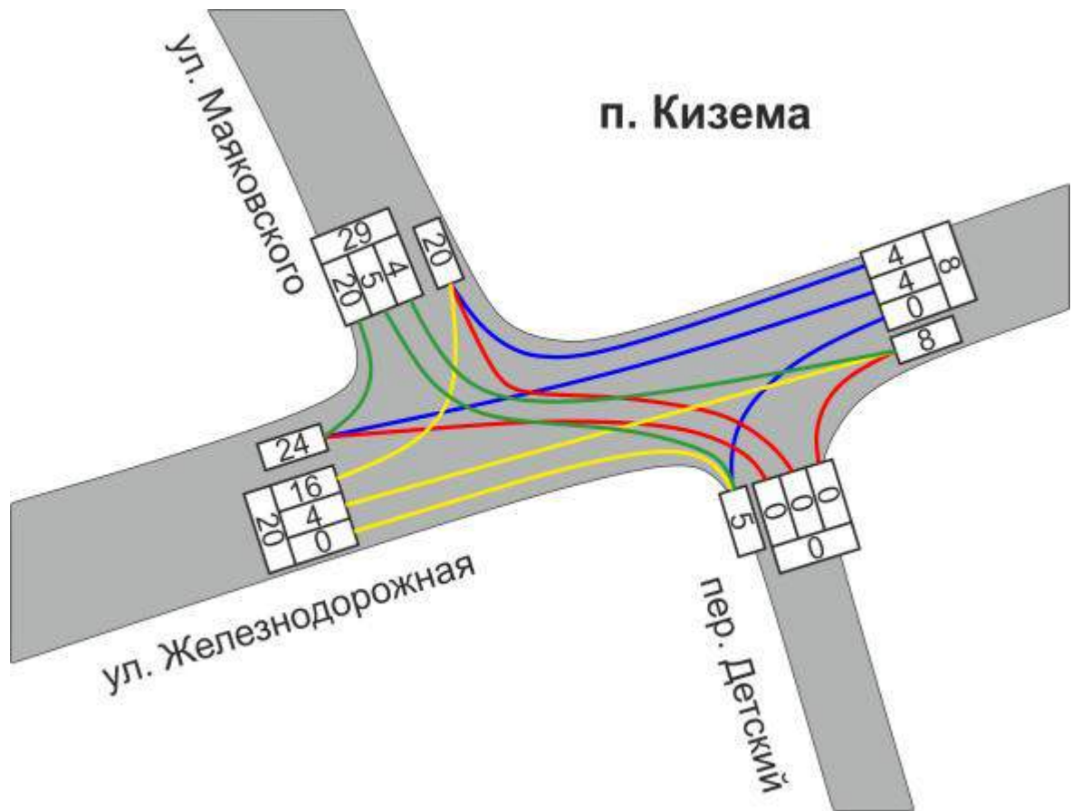
Рисунок 1.41 – Интенсивности транспортных потоков (ед/ч) на пересечении ул. Железнодорожная и ул. Маяковского п. Кизема
