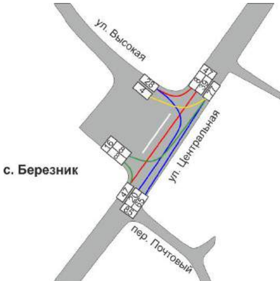
Рисунок 1.38 – Интенсивности транспортных потоков (ед/ч) на пересечении ул. Центральная и ул. Высокая с. Березник
